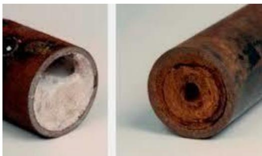
**Fig 1:** Imagen de acumulación de dureza cálcica en tuberías. Puede llegar a obstruirla completamente.
