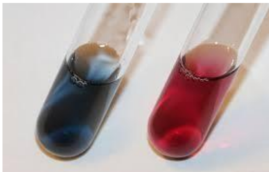
Fig 1: Cambio de coloración de azul a vino tinto según el pH
