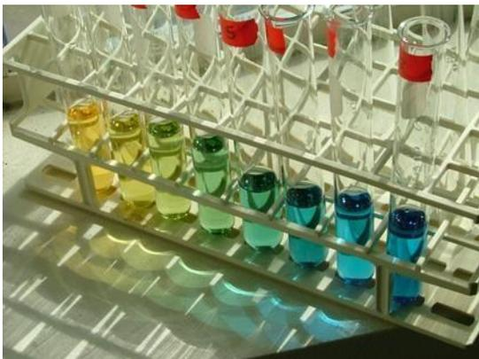
**Fig 1:** Cambio de la coloración de la muestra al realizar la titulación con el reactivo No 3.
