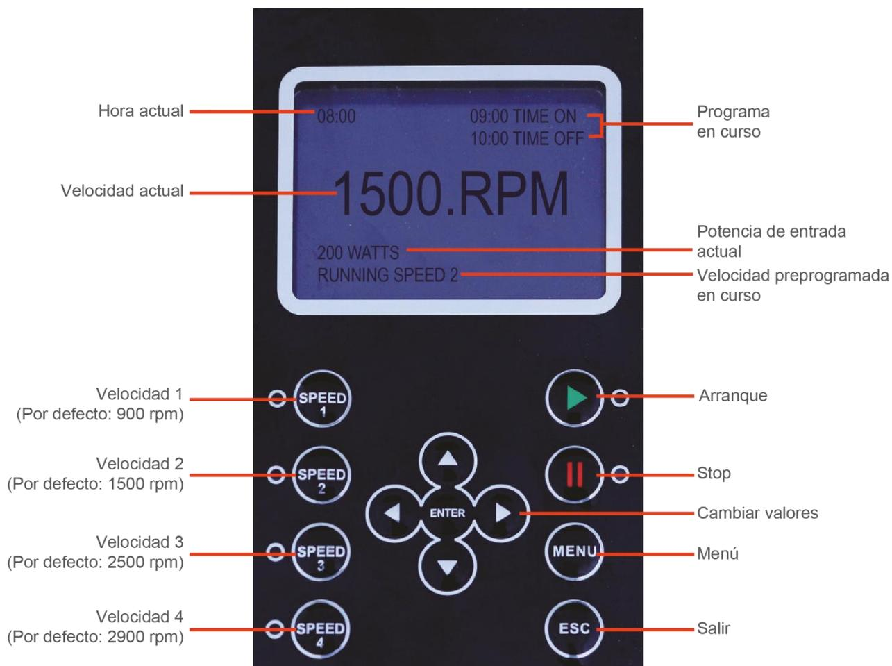
La pantalla del controlador muestra la hora, la velocidad de funcionamiento, la potencia, los ajustes de programación y los códigos de avería.
